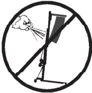
**3.7** - Si existe la posibilidad de vientos fuertes o ráfagas, coloque el elevador en el suelo con firmeza y fíjelo mediante tirantes tensores. Nunca fije un tirante a un vehículo o cualquier otro objeto que se pueda mover.
