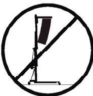
**3.4** - Este elevador NUNCA debe utilizarse para elevar una carga que no ha sido correctamente revisada. Es necesario verificar que la carga está correctamente apoyada y centrada en el soporte de elevación apropiado para que el peso de la carga sólo actúe en una dirección vertical.
