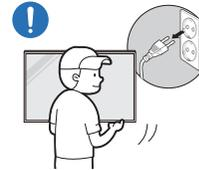
Schalten Sie vor dem Transport des Geräts den Netzschalter aus, und ziehen Sie das Netzkabel und alle anderen angeschlossenen Kabel ab.
