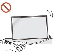
Bewegen Sie das Gerät nicht, indem Sie am Netzkabel oder an einem anderen Kabel ziehen.
