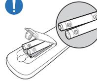
Setzen Sie jede Batterie so ein, dass Ihre Polarität (+, -) korrekt ist.
