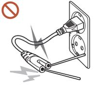
Während der Netzstecker in eine Steckdose eingesteckt ist, stecken Sie kein Essstäbchen oder einen anderen Leiter in eine verbleibende Steckdose. Berühren Sie zudem nicht sofort die Stifte des Steckers, nachdem Sie den Netzstecker aus der Steckdose gezogen haben.
