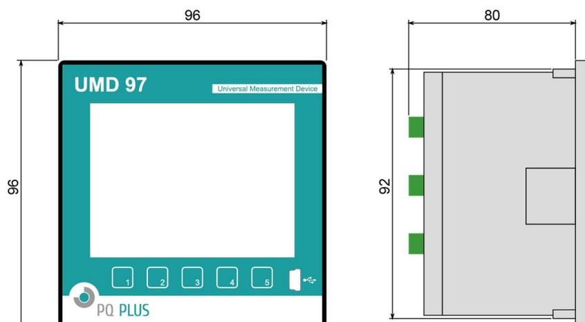
Abbildung 2: Abmessungen UMD 97.
