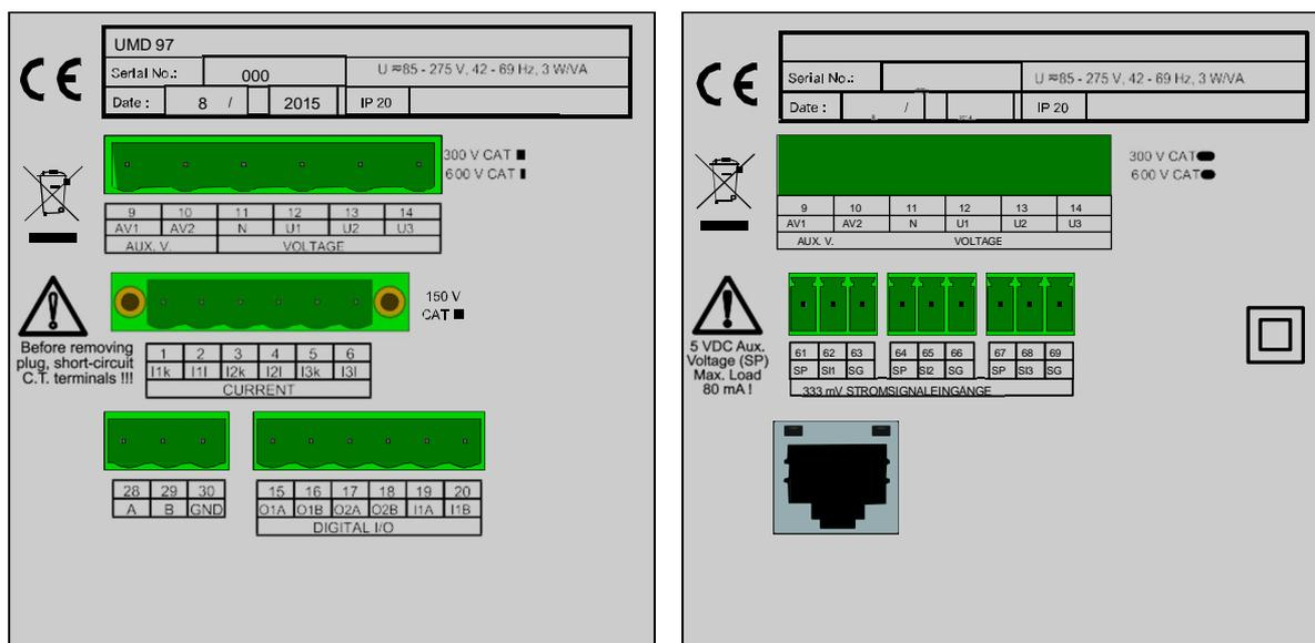
Anschlüsse für serielle RS-485-Übertragungsleitung (Option E und CBM) und ein digitaler Eingang mit zwei Relais- oder statischen Ausgängen (Relaisausgang auf Anfrage).
