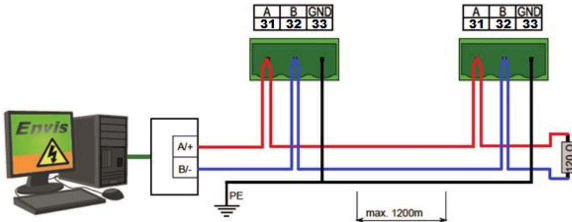
Abbildung 7: Typische Verdrahtung der RS-485-Übertragungsanschlüsse am UMD 97
