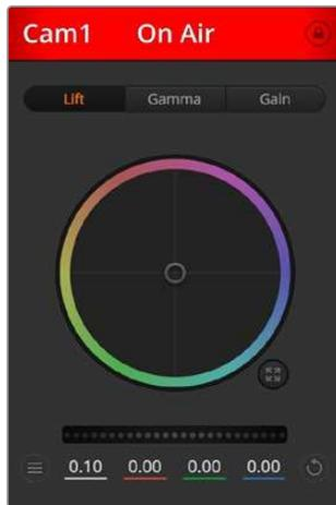
Die Kanalstatus-Box in jedem Kamerabedienfeld zeigt an, welche Kamera sich auf Sendung befindet. Justieren Sie anhand der Farbräder die Einstellungen von Lift, Gamma und Gain einzelner YRGB-Kanäle
