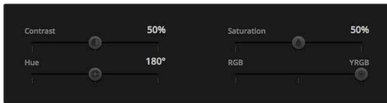
Ziehen Sie die Schieberegler nach rechts oder links, um die Einstellungen für Kontrast, Sättigung, Farbton und Luminanzmischung anzupassen.
