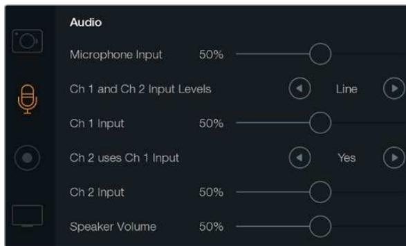
Über das „Audio“-Display lassen sich diverse Einstellungen vornehmen. Bspw. die Eingabepegel für das Mikrofon, Eingabeart und die Pegel für die Audiokanäle. Hier können Sie auch Audiokanal 1 auf Kanal 2 spiegeln und die Lautstärke für Kopfhörer und Lautsprecher einstellen
