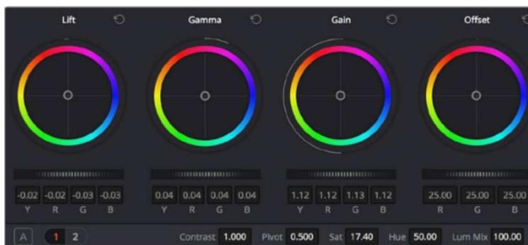
Die Farbräder „Lift“, „Gamma“ und „Gain“ geben Ihnen die volle Kontrolle über die farbliche und tonale Balance Ihrer Clips. Ziehen Sie das Einstellrad unter den Farbrädern hin und her, um jede Farbe eines jeden tonalen Bereichs einheitlich anzupassen
