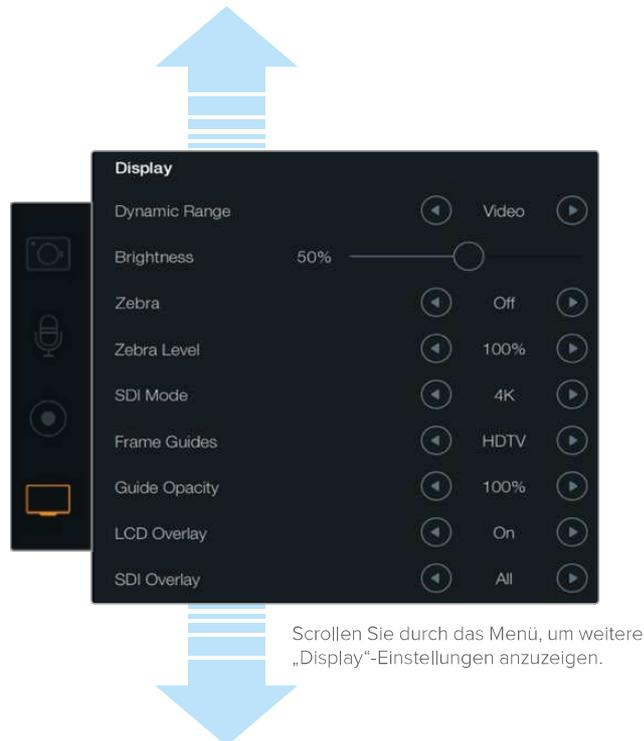
Das Display für die Anzeige-Einstellungen der Blackmagic Production Camera 4K. Über die Einstellungen unter „Display“ können Sie bei Blackmagic Kameras die Helligkeit des LCDs vorgeben, LCD-Overlays ein- oder ausschalten und den Dynamikumfang für das Display justieren sowie Zebra-Einstellungen vorgeben. Hier erfolgt auch die Auswahl der in der SDI- oder HDMI-Ausgabe Ihrer Kamera sichtbaren Overlays sowie Ihrer gewünschten Bildrandmarkierungen.
