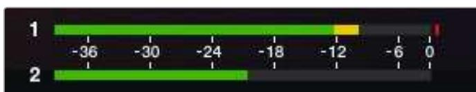
Eine optimale Tonqualität erreichen Sie mit Audiopegeln, deren durchschnittliche Spitzenwerte bei -12 dB liegen
