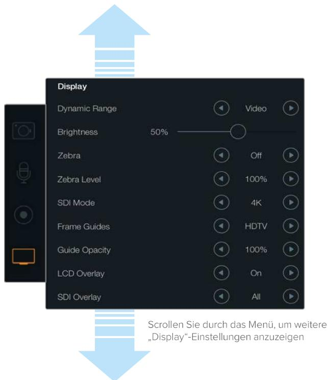
Die Bildrandmarkierungs-Einstellung der Blackmagic Kameras lässt Sie diese Overlays auf dem Kamera-LCD und in den SDI-/HDMI-Ausgaben der Kamera anzeigen.
