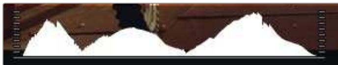
Schließen bzw. öffnen Sie die Blende für eine optimale Belichtung so weit, bis die Histogrammkurve an den jeweiligen Rändern abflacht. Ein glatt senkrecht verlaufender Rand an den Seiten des Histogramms weist auf geklippte Schwarz- oder Weißöne hin
