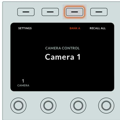
Durch Drücken der Reihen-Multifunktionstaste wechseln Sie zwischen Kamerareihen A und B, durch ihr Gedrückthalten schalten Sie eine Kamerareihe ein oder aus
