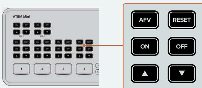
Um AFV für einen Eingang zu aktivieren oder zu deaktivieren, drücken Sie einfach seine AFV-Taste.
