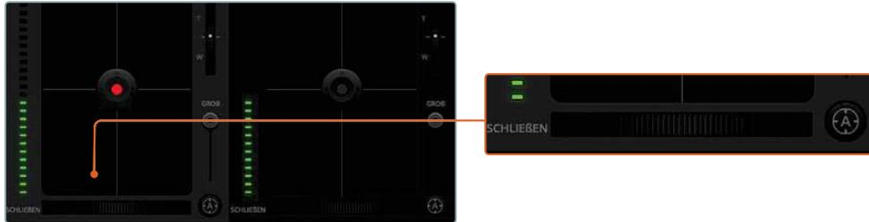
Klicken Sie zur Scharfstellung eines kompatiblen Objektivs auf das Autofokus-Icon oder ziehen Sie den Fokussier-Regler nach rechts oder links
