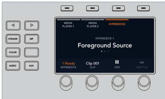
Jetzt können Sie die Drehregler unter den LCD-Anzeigen HYPERDECK, CLIP, JOG und SHUTTLE benutzen, um HyperDecks und Clips auszuwählen und in den Clips hin- und herzuspringen
