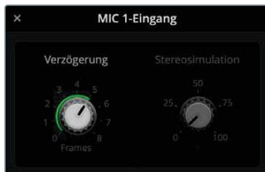
Klicken Sie auf den Verzögerungsregler und ziehen Sie ihn nach links oder rechts, um die Verzögerung für einen Analogeingang nach Bedarf zu verringern oder zu erhöhen
