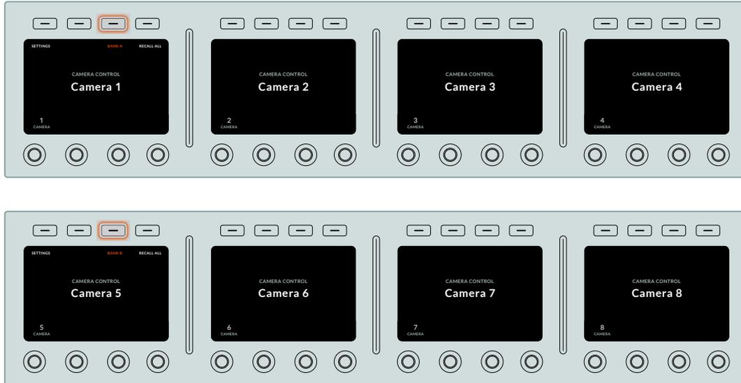
Anhand der Reihen-Einstellung lassen sich den vier CCUs je zwei Kamerareihen zuweisen, deren sofortiger Wechsel durch Drücken der Reihen-Multifunktionstaste erfolgt
