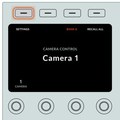
Drücken Sie auf die Multifunktionstaste EINSTELLUNGEN, um auf alle Einstellungen des Kamerasteuerpults zuzugreifen
