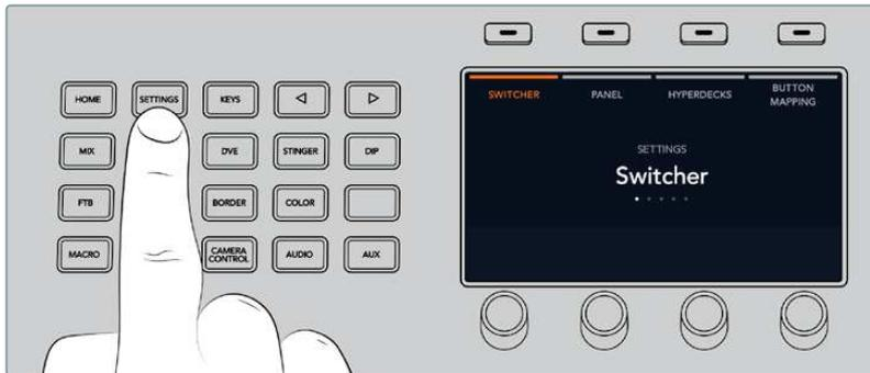
Das ATEM 1 M/E Advanced Panel zeigt Ihnen am oberen Rand des LCD-Bildschirms folgende vier Einstellungsoptionen an: MISCHER, PANEL, HYPERDECKS und TASTENBELEGUNG. Diese Optionen stehen jeweils für ein Einrichtungsmenü. Drücken Sie einfach die LCD-Multifunktions Taste über der Display-Anzeige HYPERDECKS, um das HyperDeck Einstellungsmenü zu öffnen.
