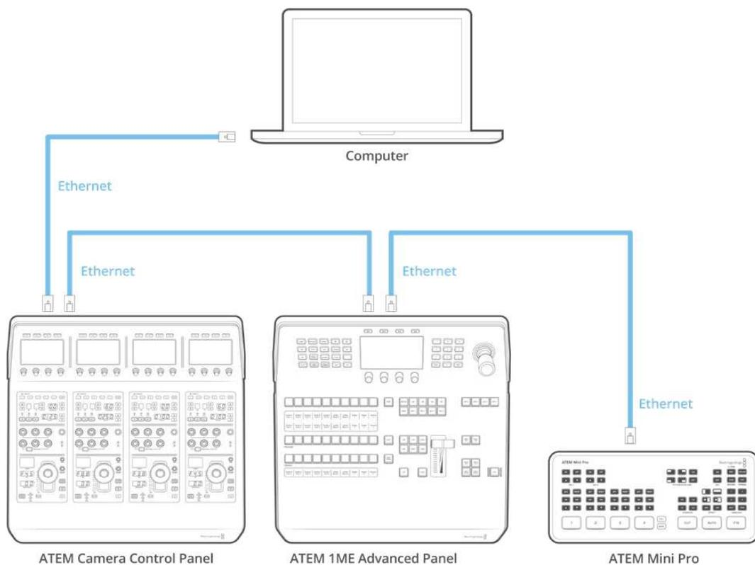
Wird das Kamerasteuerpult lediglich mit einem Mischer und einem Computer auf einem geteilten Netzwerk eingesetzt, verbinden Sie das Pult zunächst mit Ihrem Mischer und dann den freien Ethernet-Port mit Ihrem Computer.
