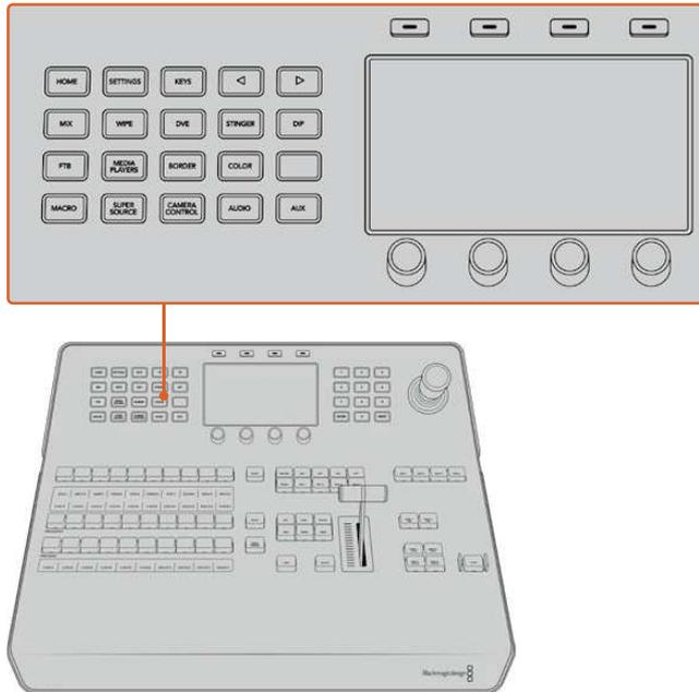
Ändern Sie die Netzwerkeinstellungen anhand der Systemsteuerungstasten und der Multifunktionsstasten
