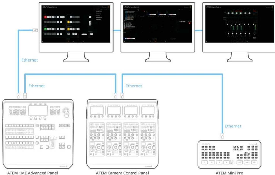
ATEM Software Control kann per Ethernet gleichzeitig auf mehreren mit einem Netzwerk verbundenen Computern eingesetzt und Ihr ATEM Mini so von mehreren Operatoren bedient werden. Bspw. könnten sich mehrere Operatoren unterschiedlichen Aufgaben wie der Medienverwaltung, Kamerasteuerung oder dem Tonmischen widmen
