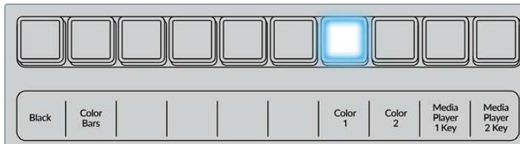
Wählen Sie bei festgehaltener SHIFT-Taste eine geschiftete Quelle aus, bspw. Farbbalken oder einen Farbgenerator
