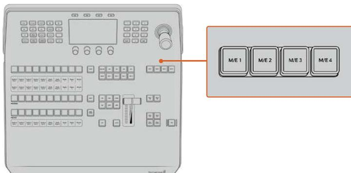
Um den zu steuernden M/E-Bus zu wählen, drücken Sie eine der von 1–4 nummerierten M/E-Tasten
