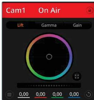
Die Kanalstatus-Box in jedem Kamerabedienfeld zeigt an, welche Kamera sich auf Sendung befindet. Justieren Sie anhand der Farbräder die Einstellungen von Lift, Gamma und Gain einzelner YRGB-Kanäle
