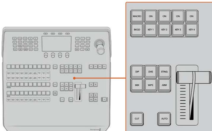
Drücken Sie CUT im Block mit den Übergangssteuertasten, um einen Übergang per Hartschnitt auszuführen
