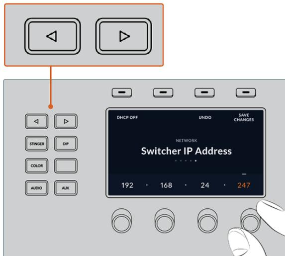
Drücken Sie auf dem ATEM 1 M/E Advanced Panel die Multifunktions-taste NETZWERK, um die Netzwerkeinstellungen auf dem LCD aufzurufen. Navigieren Sie dann mithilfe der Pfeiltasten zur Einstellung „Mischer-IP-Adresse“. Stellen Sie die IP-Adresse des Mixers mithilfe der Drehregler ein und vergessen Sie nicht, die Änderungen zu speichern.
