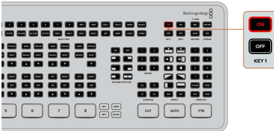
Der ATEM Mini Extreme hat vier Upstream-Keyer. Aktivieren oder deaktivieren Sie den On-air-Status des Upstream-Keyers mit der ON- oder OFF-Taste für KEY 1. Um zu anderen Upstream-Keyern zu wechseln, speichern Sie diese als Makro oder verwenden Sie ATEM Software Control. Weitere Informationen zu Makros finden Sie im Abschnitt „Verwendung von Makros“ in diesem Handbuch.
