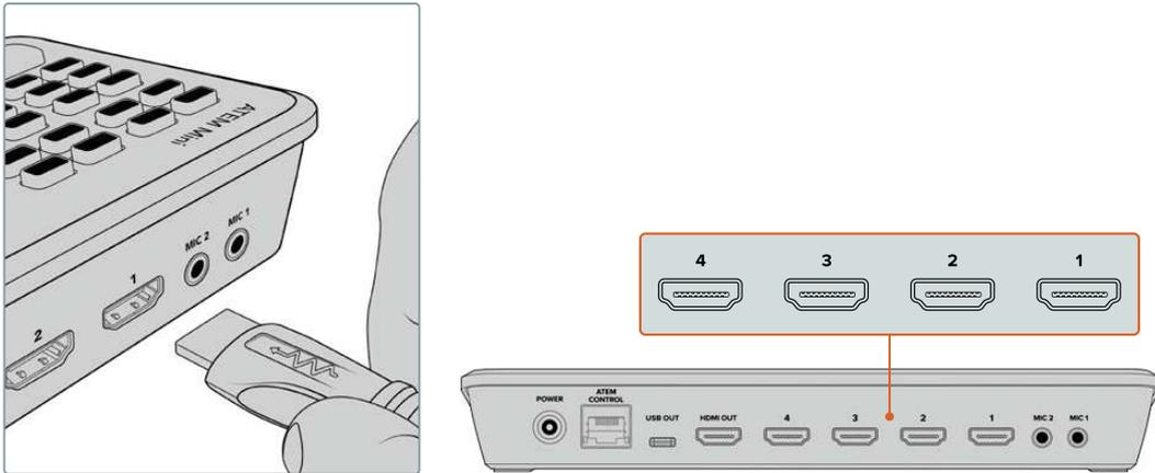
Verbinden Sie HDMI-Quellen mit den vier HDMI-Eingängen am ATEM Mini
