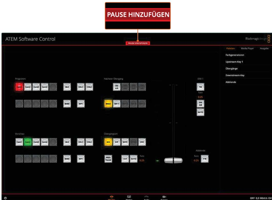
ATEM Software Control zeigt den laufenden Aufzeichnungsvorgang eines Makros anhand einer roten Umrandung an. Mithilfe der Schaltfläche PAUSE HINZUFÜGEN über der roten Linie können Sie die Pausendauer zwischen Mischervorgängen eingeben
