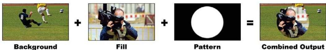
Kombinieren eines Hintergrunds mit Füllsignal und Muster-Key
