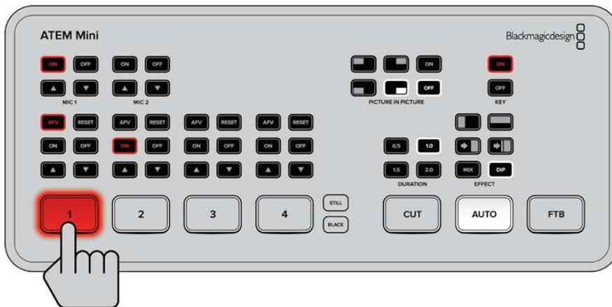
Wird im Cut-Bus-Modus eine Eingabetaste gedrückt, geht die Quelle sofort auf Sendung
