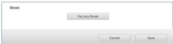
Klicken Sie auf „Factory Reset“, um die ATEM Streaming Bridge wieder auf DHCP zu setzen, damit sie automatisch in ihrem Netzwerk auffindbar ist
