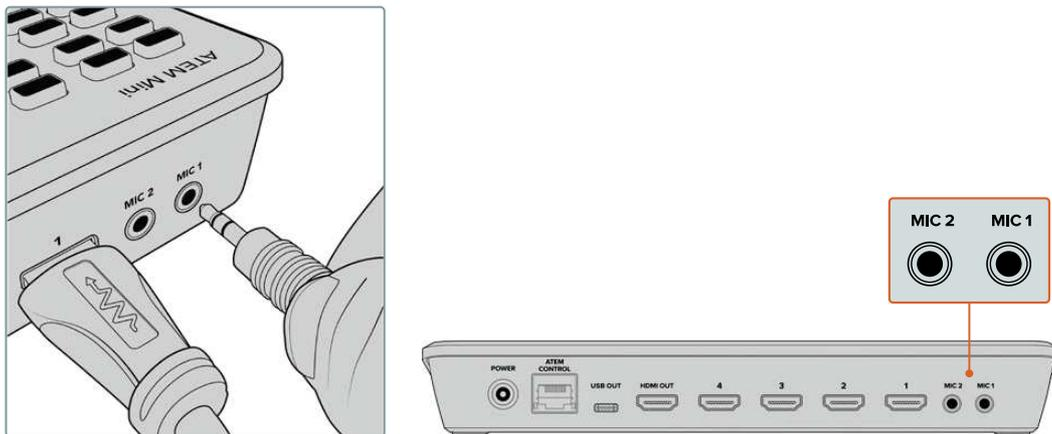
Schließen Sie Mikrofone an die MIC-Eingänge des ATEM Mini an
