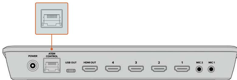
Binden Sie Ihren ATEM Mini in ein Netzwerk ein, damit Ihr Mischer über beliebige, an dasselbe Netzwerk angeschlossene Computer mit ATEM Software Control bedient werden kann
