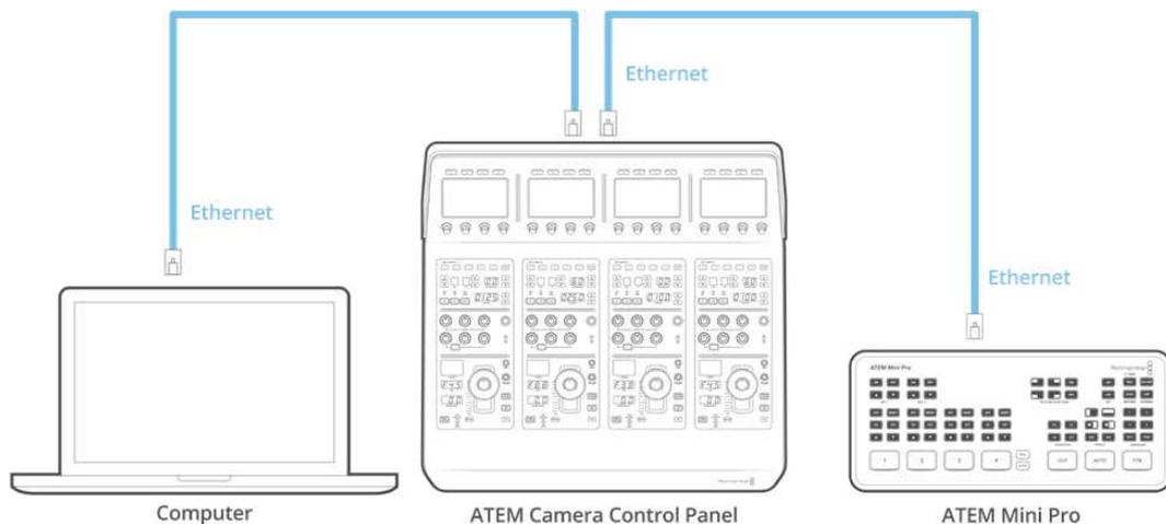
Auf dem nun mit Ihrem ATEM Equipment verbundenen Kamerasteuerpult sollten jetzt die Anzeigen leuchten und die Displays der jeweiligen CCUs die diesen zugewiesenen Kameras anzeigen. Das Pult ist nun gepowert, an Ihren Mischer angeschlossen und zum Steuern Ihrer Kameras bereit.
