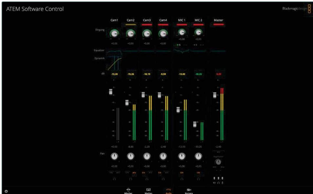
Der Audiomixer zeigt rote Tally-Lichter für alle aktuell on air befindlichen Audioquellen an und bei aktiviertem AFV zusätzlich Audiopegel, Lautstärke sowie Schaltflächen zur Auswahl des zu benutzenden Tons
