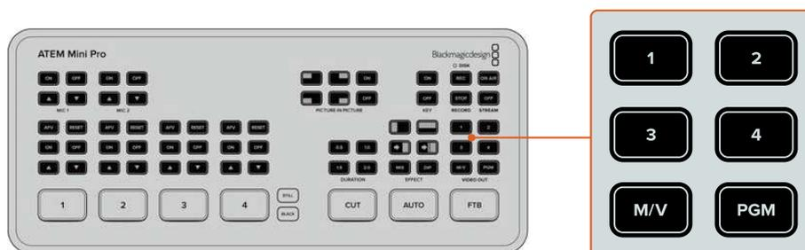
Drücken Sie eine der „VIDEO OUT“-Tasten, um eine Quelle an den HDMI-Ausgang zu legen
