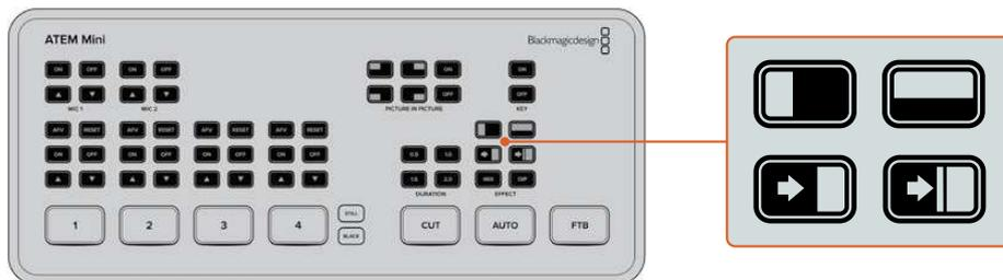
Drücken Sie die Taste für Ihren gewünschten Übergang, bspw. einen horizontalen oder vertikalen Wipe, einen Push- oder Squeeze-DVE-Übergang, oder einen Mix- oder Dip-Übergang
