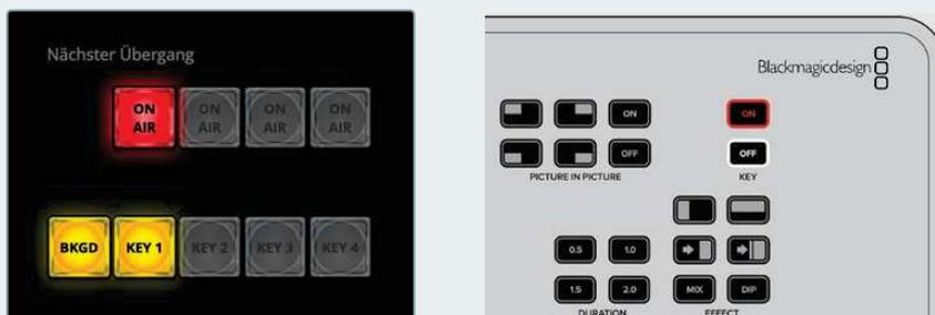
Wird die Einstellung „On Air“ im LCD-Menü geändert, wechselt auch der Status der „ON AIR“-Schaltfläche für den nächsten Übergang auf dem ATEM Software-Bedienpanel
