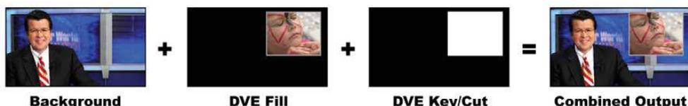
Kombination eines Hintergrundbilds mit DVE-Füllung und DVE-Key/Stanzsignal
