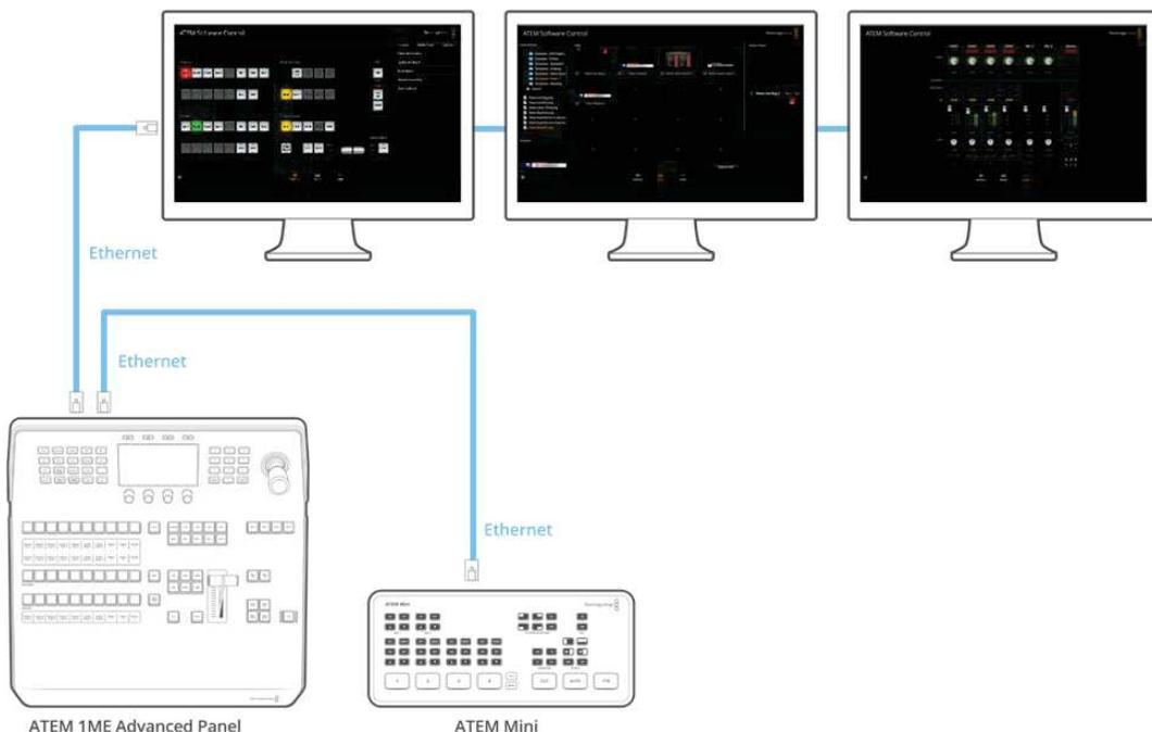
ATEM Software Control kann auf mehreren Computern zugleich eingesetzt werden. Das erlaubt die Bedienung Ihres ATEM Mini durch mehrere Leute, die sich unterschiedlichen Aufgaben wie der Medienverwaltung oder dem Tonmischen widmen
