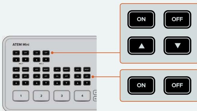
**ON** – Steht der Ton für diesen Eingang auf ON, ist er ständig zu hören. Selbst dann, wenn die Quelle aktuell nicht on air ist.
