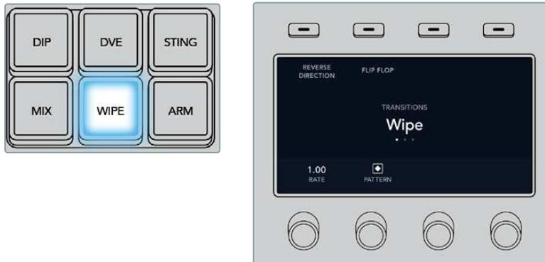
Drücken Sie in der Quellauswahlzeile eine Quelltaste, um eine Quelle für den Rand der Wischblende vorzugeben. Wählen Sie bei festgehaltener SHIFT-Taste eine geschiftete Quelle aus, bspw. einen Farbgenerator oder Media Player
