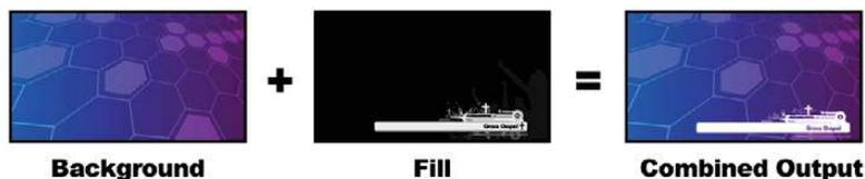
Kombination eines Hintergrunds mit Füll- und Stanzsignalen in Form eines Luma-Keys
