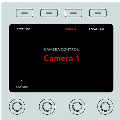
Am auf der LCD-Startseite eingeblendeten Kameranamen bzw. an der Kameranummer erkennt man die aktuell einer CCU zugewiesene Kamera
