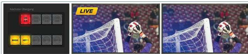
Es gibt mehrere Methoden, um einen Key auf den Programmausgang zu legen. Ein Key lässt sich ein- oder ausschalten, auf- oder abblenden oder zusammen mit einem Hintergrundübergang auf- oder abblenden. Upstream-Keys werden mithilfe der Übergangsteuerung „Nächster Übergang“ auf den Programmausgang übergeleitet. Die Überleitung von Downstream-Keys erfolgt mithilfe eigener Übergangsschaltflächen oder mithilfe der „DSK TIE“-Schaltflächen, die den Übergang an den Hauptübergang knüpfen.
