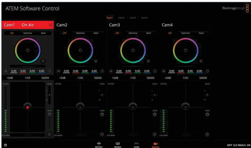
Mit der Kamerasteuerung können Sie die Blackmagic Pocket Cinema Camera 4K und 6K über einen ATEM Mini bedienen
