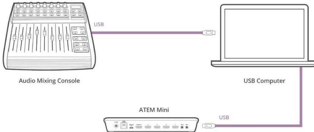
Sie können mehrere Audiopegel gleichzeitig anpassen, indem Sie ein physisches Tonmischpult an den Computer mit der Bediensoftware ATEM Software Control anschließen
