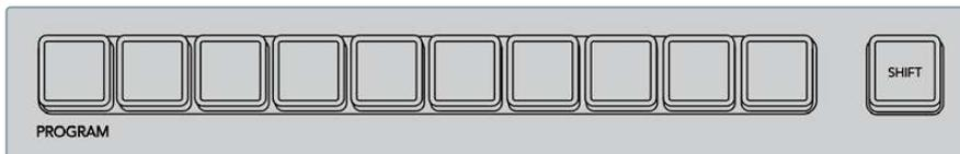
Um einen Schnitt-Übergang vom Programmbus auszuführen, drücken Sie eine der Quellentasten auf dem „Program“-Bus
