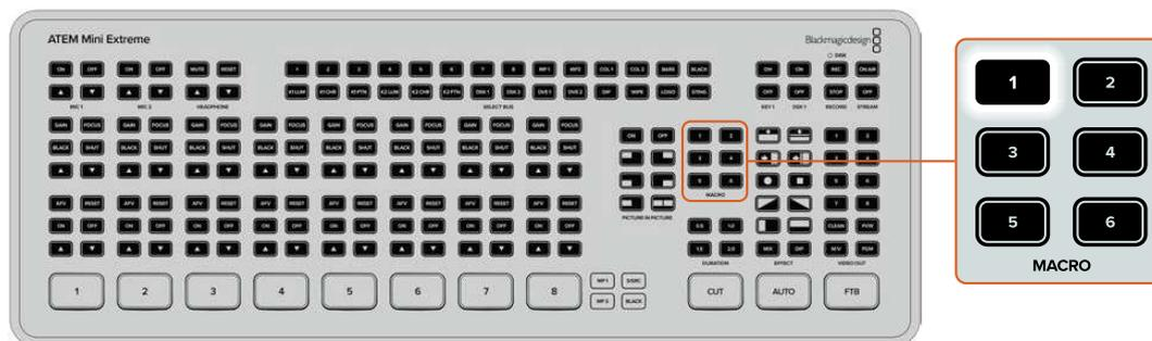
Enthält ein Makro eine unbestimmt lange Pause, „User Wait“ genannt, blinkt die Taste als Hinweis darauf, dass sie erneut gedrückt werden muss, um die Abfolge fortzusetzen
