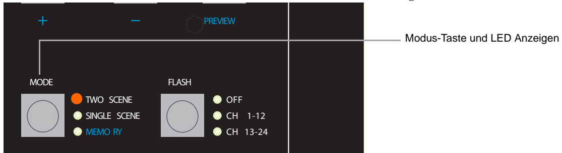
Abbildung 6: Modus-Taste LED Anzeige - Two Scene (Zwei-Szenen-Modus)
