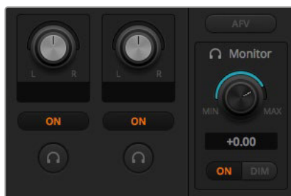
Die Monitorlautstärkereglern und -Schaltflächen dienen zur Einstellung separater Audiopegel und erlauben Solo-Monitoring auf dem Audioausgang
