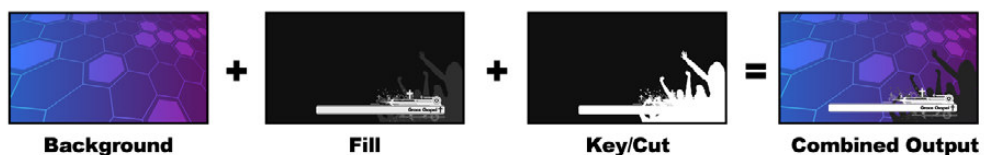
Kombinieren eines Füll- und Stanzsignals in Form eines Linear-Keys
