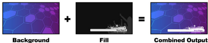
Die Kombination von Hintergrund mit Füll- und Stanzsignalen ergibt einen Luma-Key
